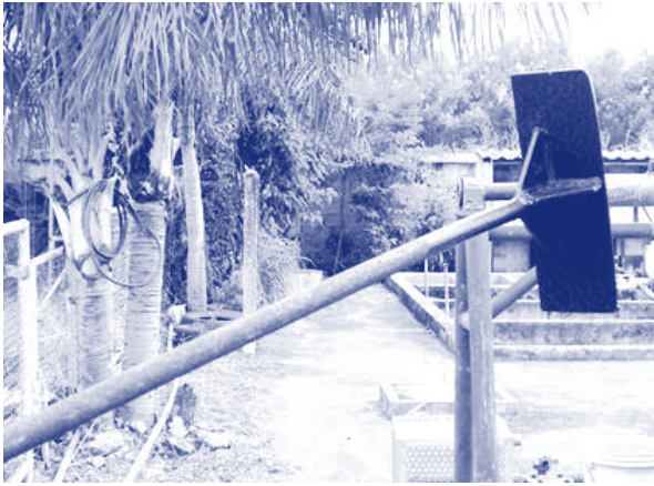
รูปที่ 3-11 อุปกรณ์สำหรับทำความสะอาดผนังด้านในของถังตกตะกอนทรงสี่เหลี่ยม
