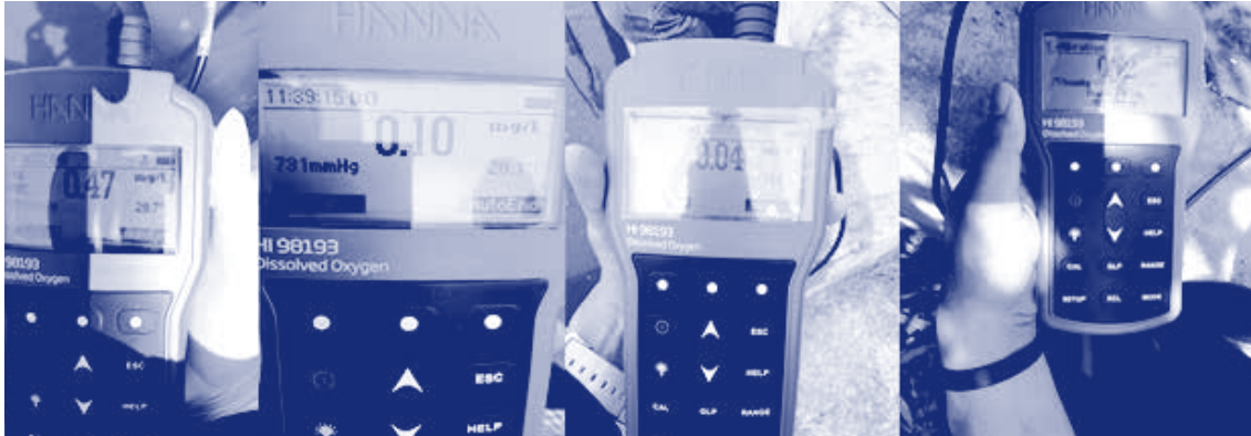
รูปที่ 7-14 ค่า DO ที่วัดได้จากถังเต็มอากาศของระบบบำบัดน้ำเสียของโรงพยาบาลหลายแห่ง
