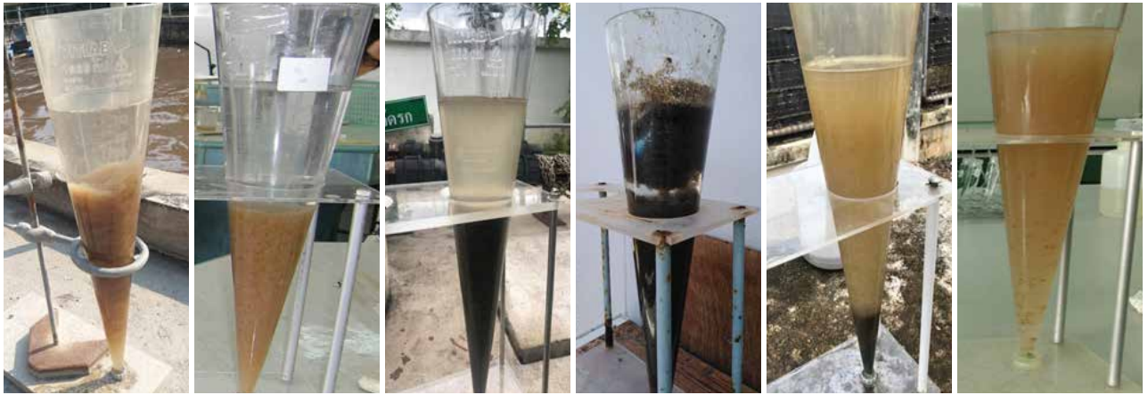
รูปที่ 5-8 ลักษณะการตกตะกอนของสลัดจ์แบบต่าง ๆ ในการทดสอบ SV30 ทั้ง 6 รูปแบบ
