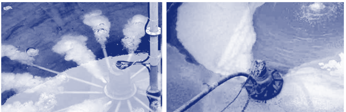
รูปที่ 2-28 เครื่องเติมอากาศแบบจมน้ำ
