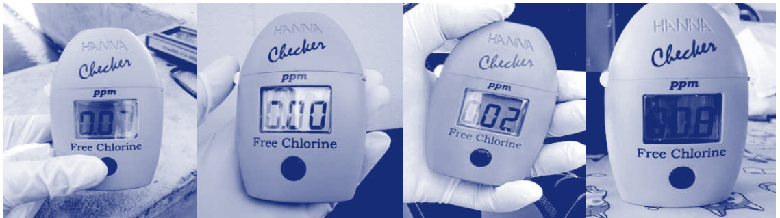
รูปที่ 7-21 คลอรีนอิสระที่เหลืออยู่ต่ำกว่า 0.5 มก./ล.หลังจากทำปฏิกิริยา 30 นาที
