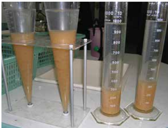
รูปที่ 5-4 การทดสอบการตกตะกอน SV30 ด้วยกรวยอิมฮอฟฟ์และกระบอกตวง
